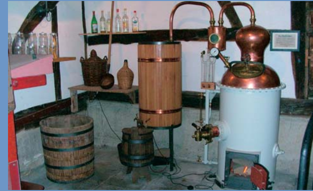
Die Brennblase dient der Herstellung von Alkohol. Er verdampft bei einer bestimmten Temperatur aus der Maische und schlägt sich in der Kühltangabe nieder.
