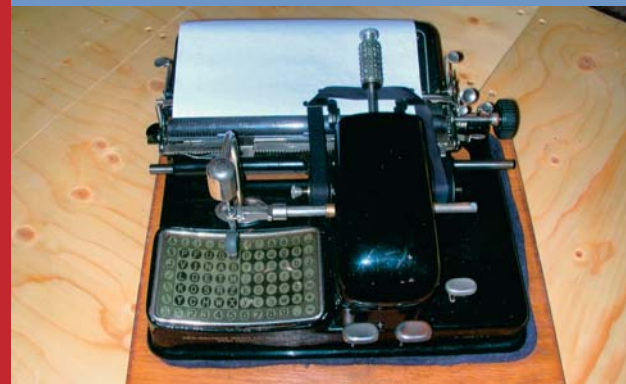
Die Schreibmaschine „Mignon AEG“ Modell 4 wurde 1920 von der „AEG-Deutsche Werke A.G.-Berlin, Werk Erfurt“ hergestellt. Als „Eintaster“ arbeitet sie ohne Buchstabentasten.
