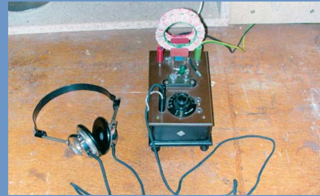
Der Detektor, die einfachste Form eines Radioapparates, kann die Funkwellen ohne Hilfe zusätzlicher elektrischer Energie empfangen und hörbar machen.
