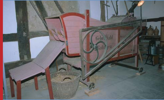
Diese Dreschmaschine der Firma Gebr. Wahl (Balingen) aus den 1930er Jahren war auch noch nach dem 2. Weltkrieg im Gebrauch.
