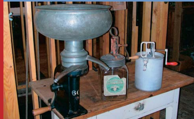
Butterfass und Zentrifuge dienen der Gewinnung der fetten Bestandteile der Kuhmilch. Beim Schlagen des Rahms im Fass entsteht Butter, in der Zentrifuge wird Schlagrahm (Sahne) erzeugt.
